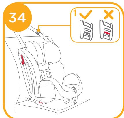
! Als de hellingshoek wordt aangepast, controleer dan de spanning op het bovenkoord of maak het los om de hoek aan te passen en span het opnieuw.
