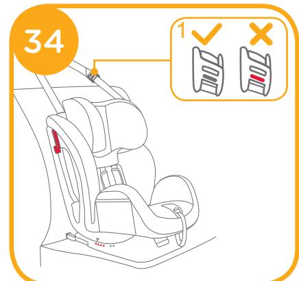
! Podczas regulacji kąta nachylenia, należy sprawdzić napięcie górnego pasa mocującego lub poluzować w celu regulacji, a następnie napiąć ponownie.
