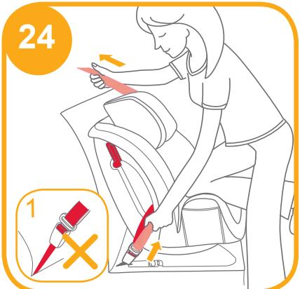
4. Раскройте фиксирующий механизм и пропустите через него ремень безопасности. **25**
